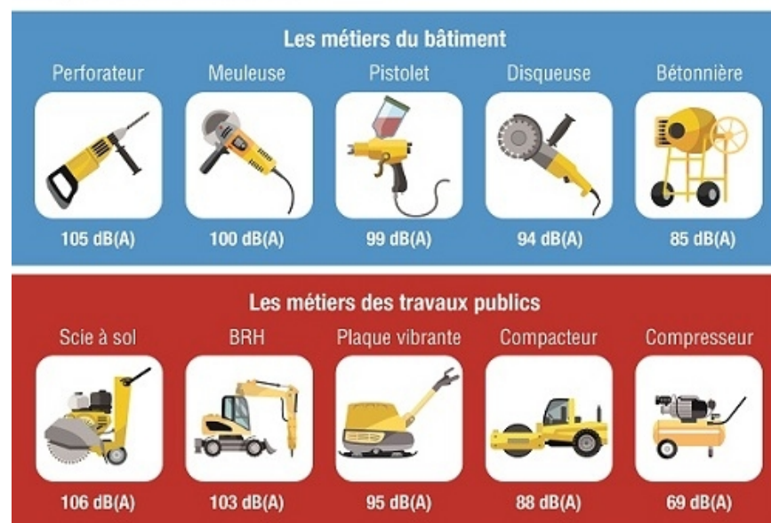
Figure 14: Nuisances sonores émises par les outils et les engins du chantier
